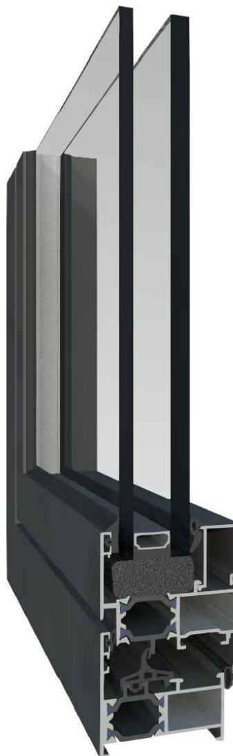
Série de batente com rutura térmica, composta por semi-perfis de alumínio extrudido, unidos com barras de poliamida de 24 mm, reforçada com fibra de vidro.
