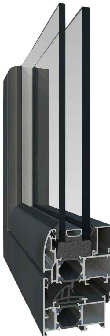
Série de batente com rutura térmica, composta por semi-perfis de alumínio extrudido, unidos com barras de poliamida de 24 mm, reforçada com fibra de vidro.
