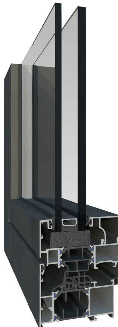
Série de batente com rutura térmica, composta por semi-perfis de alumínio extrudido, unidos com barras de poliamida de 34mm, reforçada com fibra de vidro.
