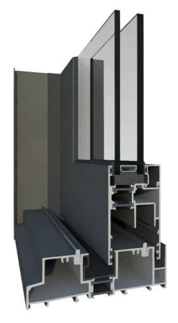
Sistema de correr elevável, composto por semi-perfis de alumínio extrudido, unidos com barras de poliamida de 24mm, reforçada com fibra de vidro.
