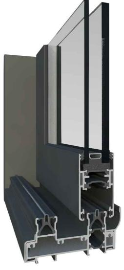
Sistema de correr/elevável, composta por semi-perfis de alumínio extrudido, unidos com barras de poliamidas, reforçada com fibra de vidro e inversor de corte térmico (T-REX) no aro fixo, eliminando, assim, perdas energéticas transversais e longitudinais.
