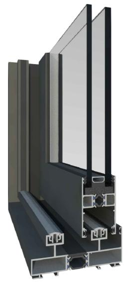
Série de batente com rutura térmica, composta por semi-perfis de alumínio extrudido, unidos com barras de poliamida, reforçada com fibra de vidro.
