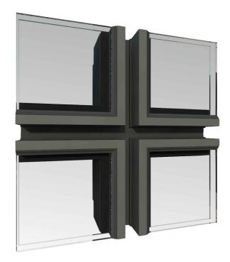
Sistema de fachada semi-estrutural, composto por prumos e travessas com 55mm de largura e envergadura variável. Constituído por quadros que incluem uma aba exterior que sustenta os vidros, evitando assim a necessidade da colagem.
