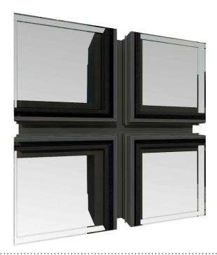
Sistema de fachada estrutural (Vidro Exterior Colado), composto por prumos e travessas com 55mm de largura e envergadura variável. Apresenta uma superfície exterior plana constituída por uma quadrícula de vidros sem alumínio visível, sendo estes fixos nos perfis que constituem os quadros através de um processo de colagem executado por vidreiras especializadas.
